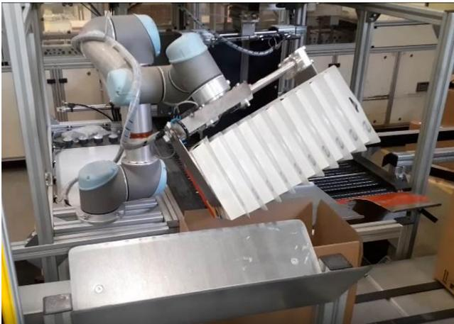
Abbildung 2-3: Mechanische Zentrierung im Verpackungsprozess
