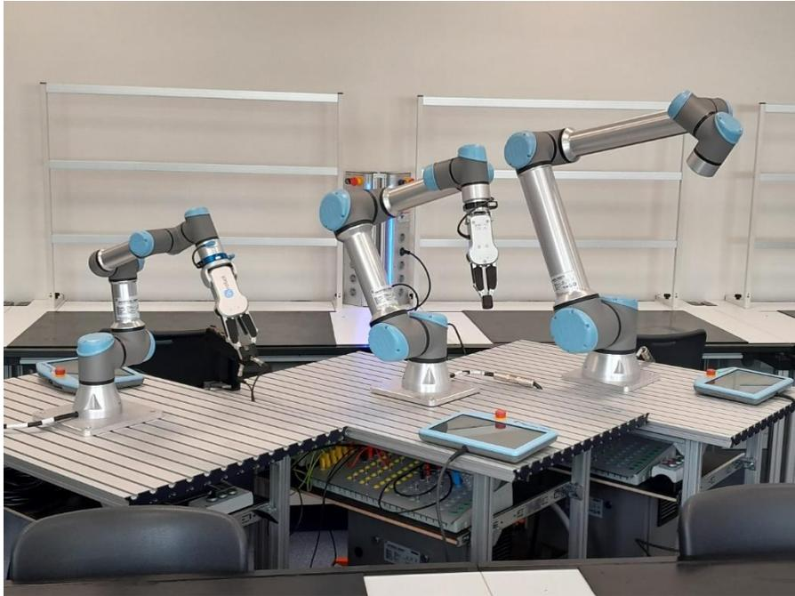
Abbildung 5-5: UR3e, UR5e und UR10e der Firma Universal Robot
