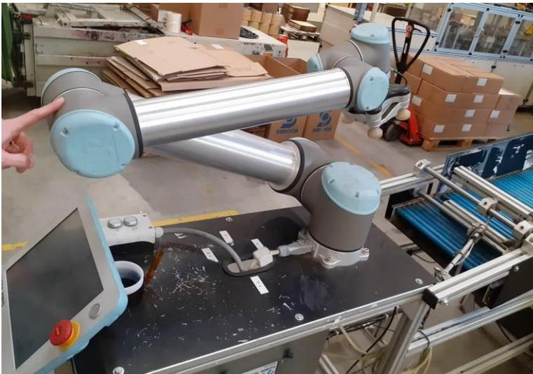
Abbildung 2-1: Palettierung von Produkten mit einem Cobot
