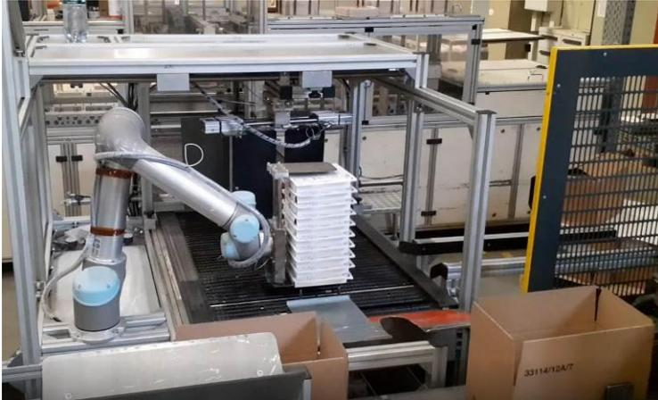
Abbildung 2-2: Aufnahme von Klebebandrollen zur Verpackung in Kartons
