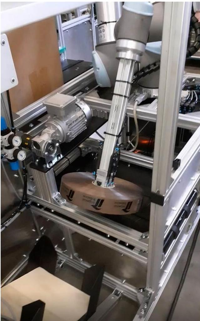
Abbildung 2-5: Verpackung von schweren Kleberollen
