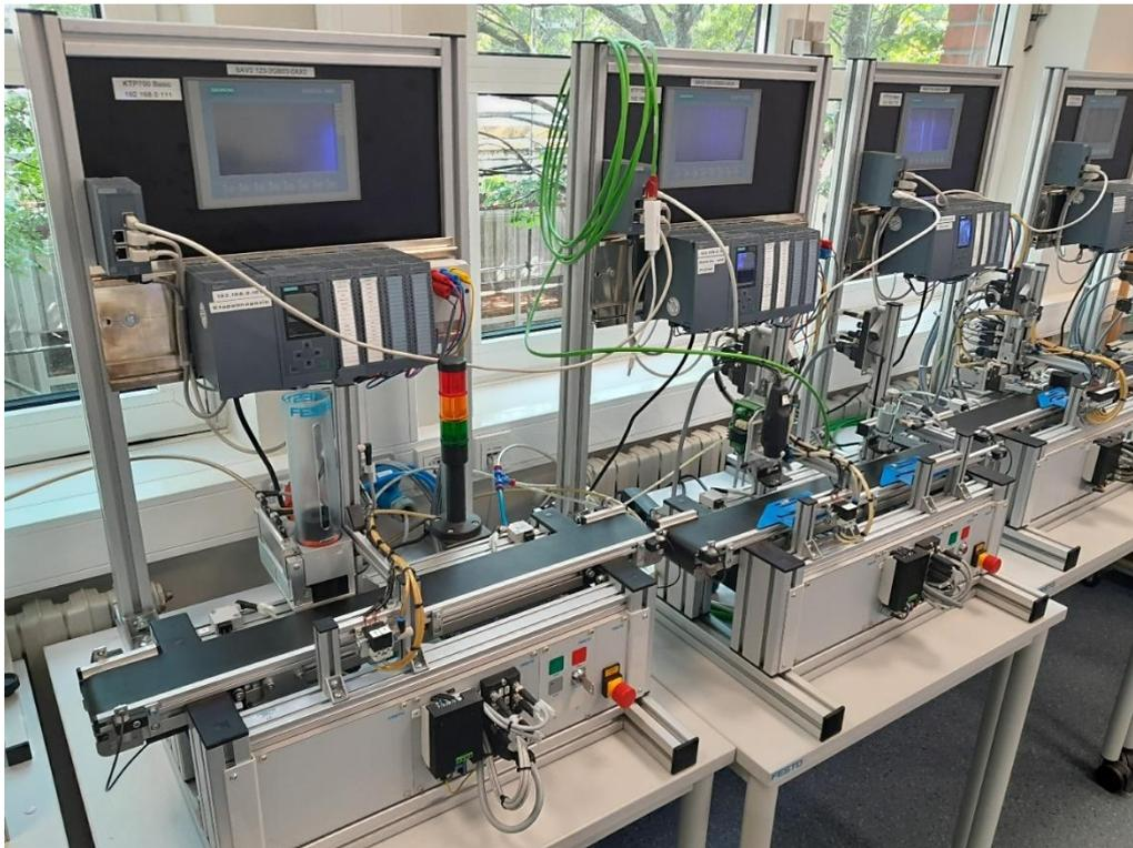
Abbildung 5-2 FESTO Didactics MPS-Transportband-System mit Erweiterungsmodulen (v.l. 1. Stapelmagazin, 2. Bohren und Tiefenprüfung, 3. Bauteile wenden, 4. RFID lesen, schreiben und Auswerfen)
