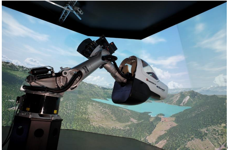
Flugsimulator mit einer CAVE
